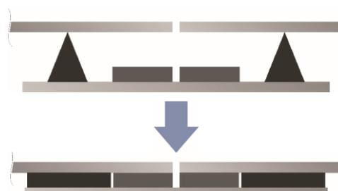
**Важно:** Монтаж панелей должен быть закончен в течение 15 минут с момента нанесения клея на основание.
